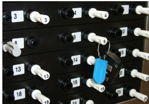
Abb. zeigt deponierten Schlüsselstecker
